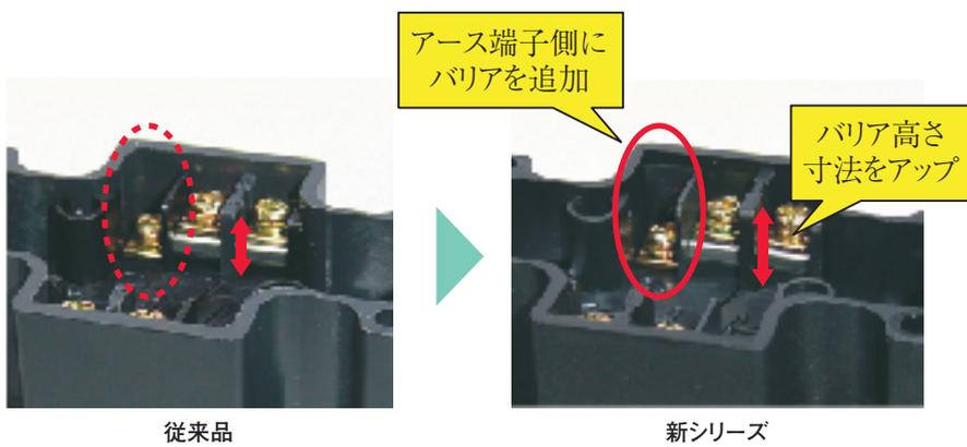
図4.集中端子箱バリア構造の比較
