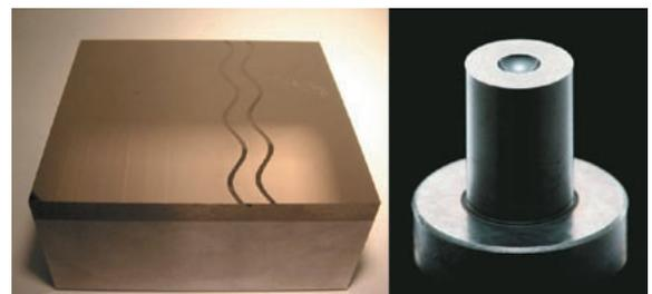
図1 プラスチック成形金型の一例
