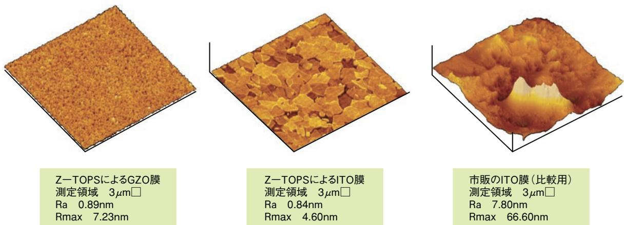
図6 AFMによる表面粗さ測定
