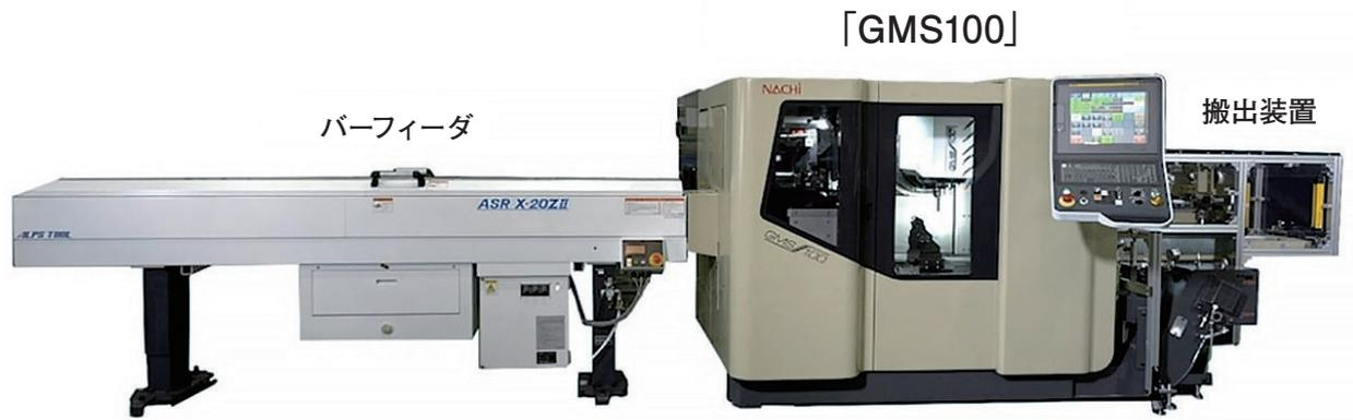
図11 バーフィーダ+搬出装置の適用例
