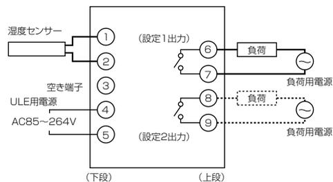
(設定2出力)は、2サーモ型の制御出力及び単機能+タイマ付上下限警報型の警報出力となります。単機能型は、空き端子です。
